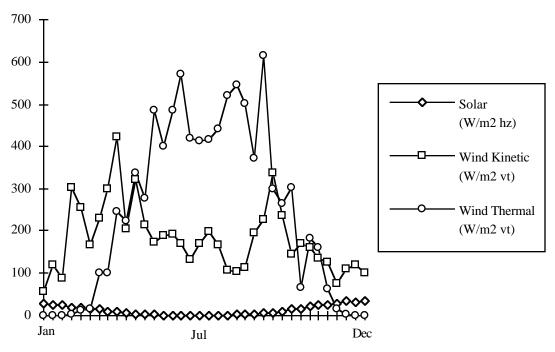
Fig. 1: An Estimate of Recoverable Energy at Dumont d'Urville. Data Source: Le Goff, H., Laboratoire des Sciences du Génie Chimique
